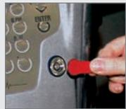
Zugangskontrolle mittels elektronischem Schlüssel (optional)
