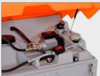
Elektrozahnpumpe 230V, 9l/min, 12 bar und digitaler Handdurchlaufzähler für Schmierstoffe
