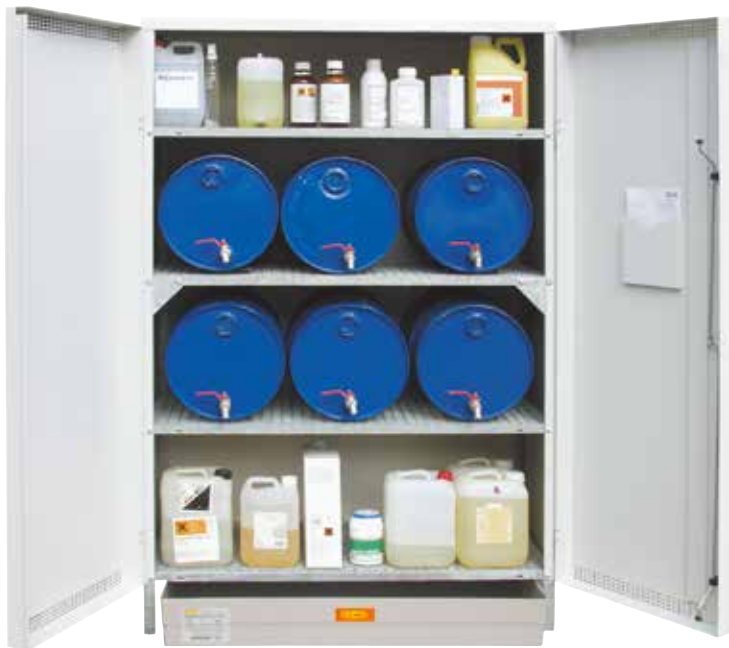
Beispiel: Umweltschrank 13/20 mit GFK-Auffangwanne 150l und 4 Gitterrosten
