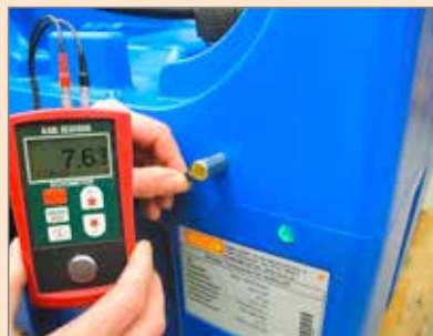
Wanddickenprüfung an einem PE Tank
