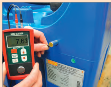
Wanddickenprüfung an einem PE Tank
