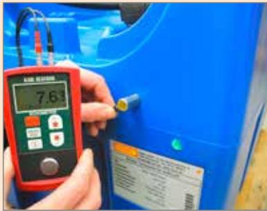
Wanddickenprüfung an einem PE Tank
