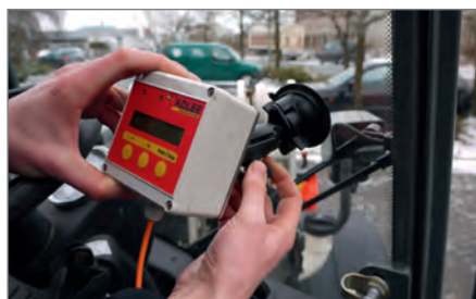
Anbringung des Bedienteils an der Frontscheibe
