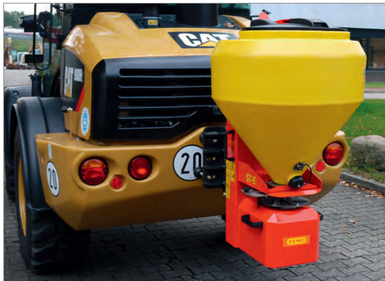
Elektro-Salzstreuer ST-E 120 mit kippbarer Universalaufnahme, als Zubehör
