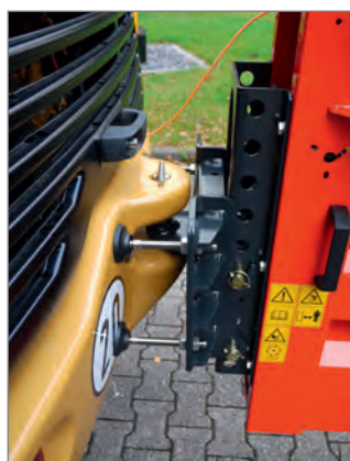
Elektro-Salzstreuer ST-E 120 mit kippbarer Universalaufnahme, als Zubehör
