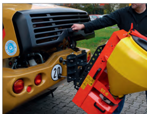
Universalaufnahme kippbar, als Zubehör (Zugang Motorraum möglich)
