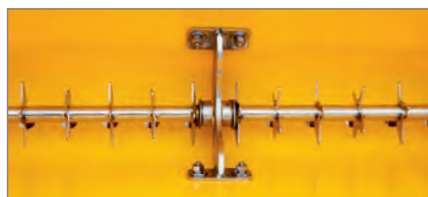
robuste Rührwelle, Achse mittig geteilt
